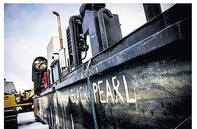
Stödbenspråmarna har ben som kan fästas 8 meter ner i havsbotten. FOTO: FELIX RANTSCHUKOFF
