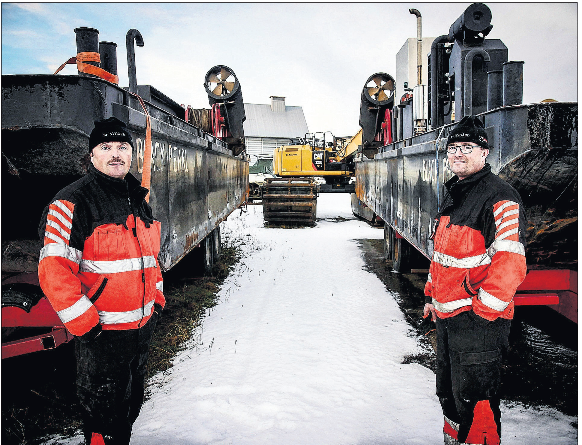
Klaus och Glenn Nygård visar upp två av deras stödbenspråmar för muddringsarbete.
